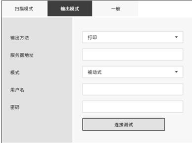
该截图显示了“发送到打印机”配置窗口的“输出模式”选项卡。窗口顶部有三个选项卡：“扫描模式”、“输出模式”和“一般”，其中“输出模式”处于选中状态。左侧边栏包含以下配置项：输出方法（下拉菜单，显示“打印”）、服务器地址（文本输入框）、模式（下拉菜单，显示“被动式”）、用户名（文本输入框）和密码（文本输入框）。右侧主区域包含一个“连接测试”按钮。
