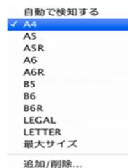
「自動で検知する」を選択すると、原稿のエッジを検知して原稿のサイズに合わせた画像が保存されます。また「自動で検知する」が選択された状態のみ、「詳細設定」をクリックしたときに表示されるダイアログボックスの「トリミング」が有効になります。
