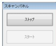
次の原稿をセットしてから、スキャンパネルのスタートボタンをクリックすると、セットされた原稿のスキャンが開始します。
