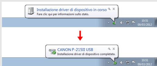
Quando lo scanner è correttamente collegato al computer, l'icona
