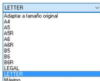
Si se selecciona [Adaptar a tamaño original], se detectan los bordes del documento y se guardan las imágenes cuyo tamaño coincide con el del documento. Además, solo se habilita [Recorte] en la pestaña [Procesando imagen] cuando se selecciona [Adaptar a tamaño original].
