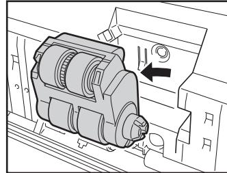
**4** 请先连接右侧以安装新的送入滚轴。
