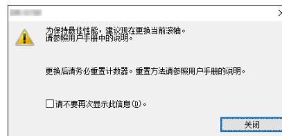
如果启动时出现此消息, 请购买一套更换滚轴工具包, 用工具包 (送入滚轴和减速滚轴) 中包含的消耗品更换已磨损的部件。有关更换滚轴工具包的详细信息, [请参阅第 59 页](#)。
